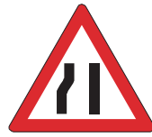
W330 Barabara nyembamba kutoka upande wa kushoto
